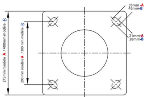
Principe de scellement du kit d'ancrage
