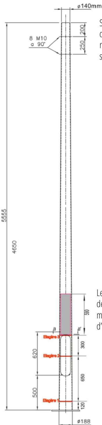
Système de double rangée de vis en tête permettant la réception de crosses spécifiques pour caméras
