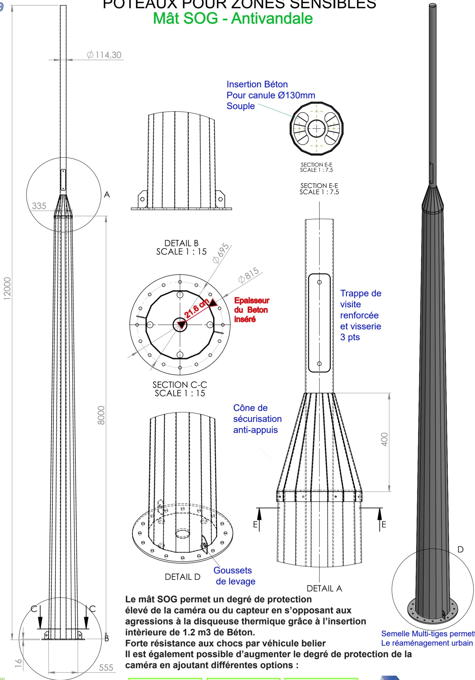
**Le mât SOG permet un degré de protection élevé de la caméra ou du capteur en s'opposant aux agressions à la disqueuse thermique grâce à l'insertion intérieure de 1.2 m3 de Béton.**
