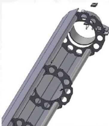
**B** - Un système externe breveté qui permet grâce à deux demi-coquilles équipées pour chacune d'entre elles de **6 tubes spécifiques, amovibles et remplaçables**. Ces deux demi coquilles **s'assemblent en formant une enveloppe externe sur toute la périphérie du mât** afin de le protéger contre les attaques à la disqueuse autonome. Ceci en **retardant, en bloquant ou bien en chassant le disque malveillant d'une meuleuse autonome**.
